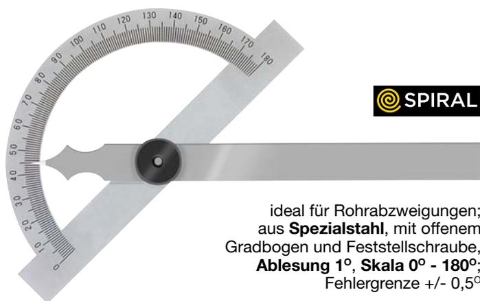
ideal für Rohrabzweigungen; aus **Spezialstahl**, mit offenem Gradbogen und Feststellschraube, **Ablesung 1°, Skala 0° - 180°**; Fehlergrenze +/- 0,5°
