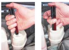
**Funktionsweise:** die Bremsflüssigkeit nimmt Wasser aus der Luft auf und verändert dadurch den Siedepunkt (Dampfblasenbildung); während der Benutzung wird der Bereich vom Siedepunkt zum Nass-Siedepunkt durchschritten (230-170°C); der Nass-Siedepunkt stellt das Ende der Lebensdauer der Bremsflüssigkeit dar; bei 4% Wasseranteil muß die Bremsflüssigkeit ausgetauscht werden
