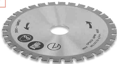
**ACHTUNG:** diese Kreissägeblätter dürfen nur auf Maschinen mit **max. 1.800 U/min.** eingesetzt werden, wie z.B. **SPEEDY-MAX**; andere Maschinen, wie z. B. Tisch-Kreissägemaschinen, nur in Verbindung mit einem **Frequenzumformer** für die Drehzahlreduzierung auf 1.800 U/min!
